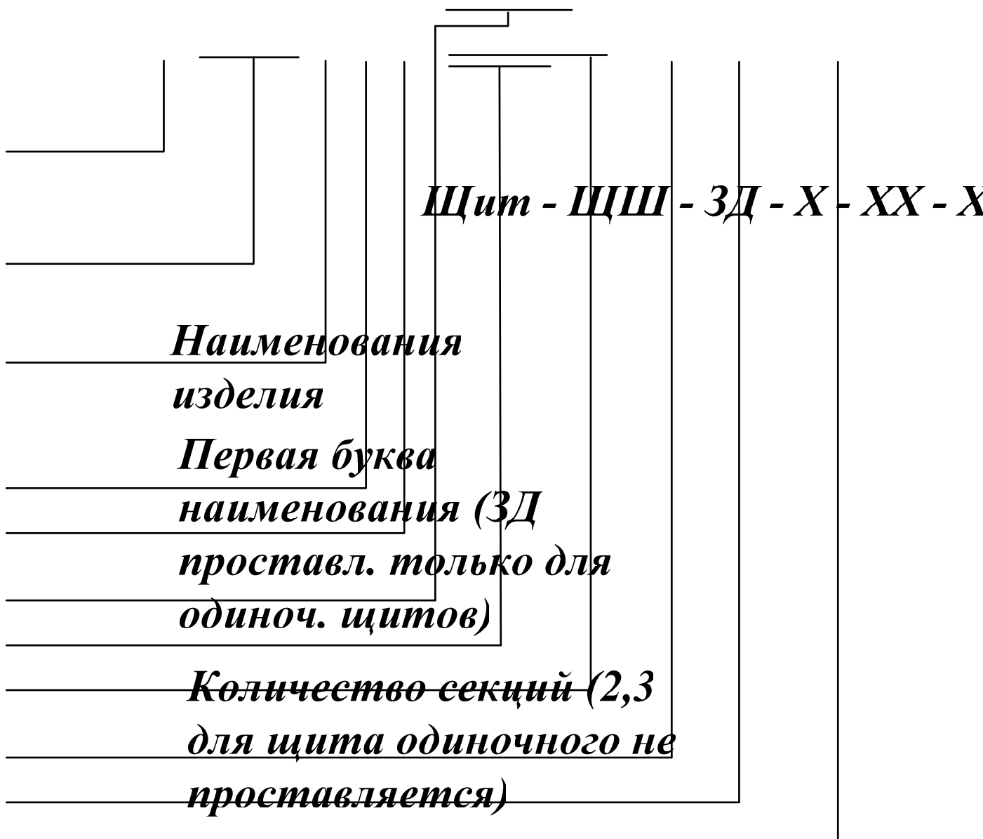
Рисунок 7.4 Структура построения условных наименований щитов шкафов с задней дверью одиночных двух- или трехсекционных Степень открытия боковых сторон щита (О2, ОП, ОЛ, при двух закрытых бок. сторонах щита не проставлять)
